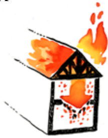
Le feu de comble retombe dans les étages par la chute de matières enflammées ou même de charpentes.
