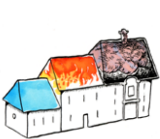
Surveiller les volumes de combles au-dessus du feu. Ils peuvent se remplir de gaz et fumées. Le niveau bas est moins menacé.
