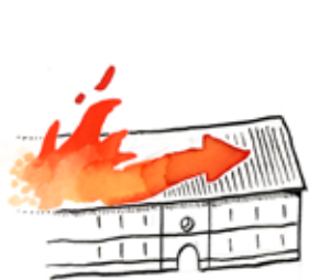
La propagation d'effectuer en avant du feu, les volumes de comble encore intacts retiennent les gaz chauds prêts à s'enflammer.
