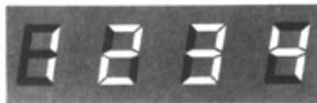
Anzeige von Ziffern mit Hilfe von Halbleiter-Leuchtdioden oder Flüssigkristallen. Kleinflächige Anzeigen in Meßinstrumenten oder kleinen Taschenrechnern mit hoher Leuchtkraft und langer Lebensdauer; bald auch in unseren Autos auf den Armaturenbrettern. Große Anzeigen, beispielsweise auf Flughäfen oder Überwachungseinrichtungen mit Flüssigkristallen und niedrigem Stromverbrauch.
